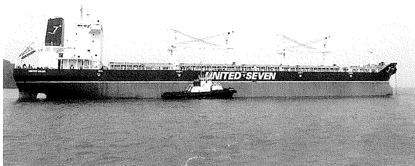
Die 190 Meter lange „United Jalua“ ist mit vier 36-Tonnen-Bordkränen ausgerüstet
